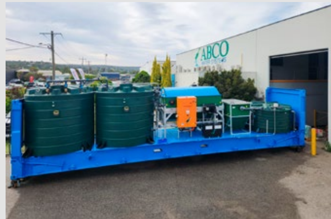
Taşınabilir mobil atıksu arıtma sistemi, kiralama amaçlı Avustralya'da inşa edilmiştir.
